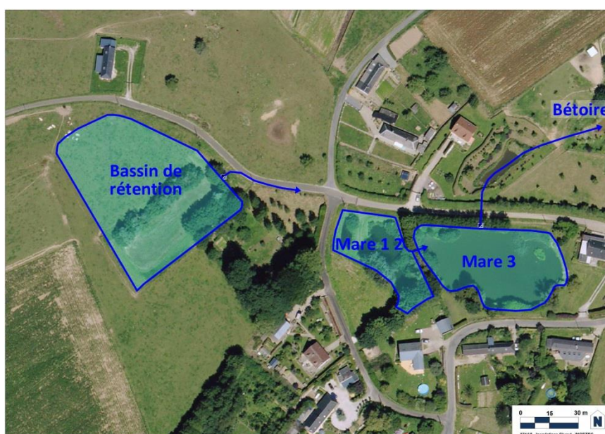
Schéma 25 : Localisation des ouvrages mis en œuvre pour assurer la protection du hameau contre les inondations jusqu'à la pluie d'occurrence décennale
